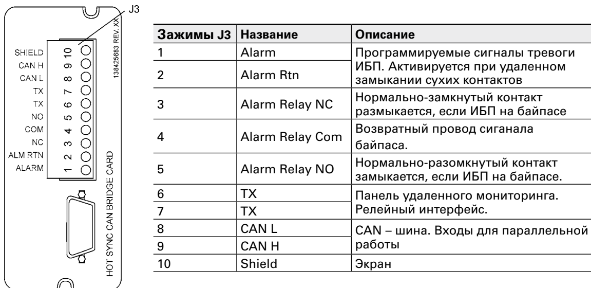
Рисунок 50. Плата XSlot Hot Sync и контактный интерфейс
